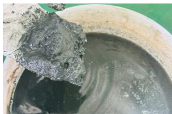
タンクの底に溜まった スラッジの回収
