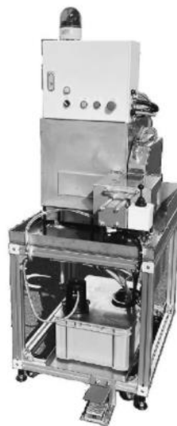
新型の湿式半自動切断機 入もスムーズに行える。
